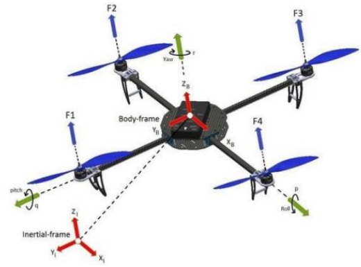
Gambar 2. 2023 didesain oleh tim Hayago menggunakan Inventor 3D desain gambar 3D model dinamik dari quadcopter
