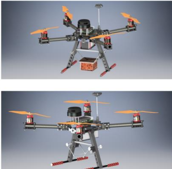
Gambar 1. 2023 didesain oleh tim Hayago menggunakan Inventor 3D desain gambar 3D desain Hayago quadcopter drone delivery
